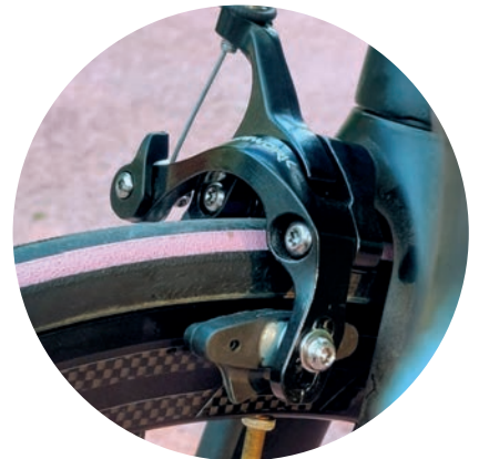
Bremser hjulene med kabler
